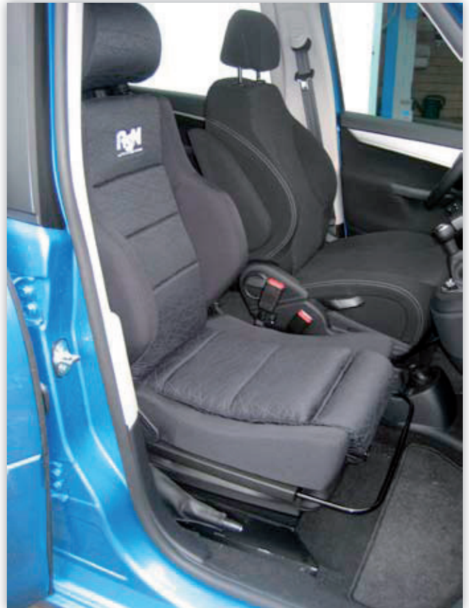
Einbaubeispiel Citroen C4 Beifahrerseite (Fahrerseitig auch lieferbar). Mit seiner 50mm Luftfederung, verhindert der K 331 optimal Fahrzeug- und bodenbedingte Schläge bis zu 70%. Ein fantastischer „Lufttritt“.
