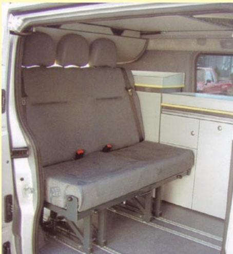
Freizeitfahrzeug mit Sitz-Liege-Kombination (auch die Schränke sind auf Schienen befestigt)
